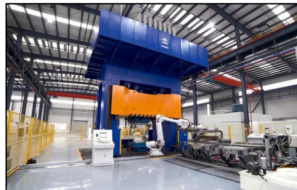
2018年度课题：4000吨高性能复合材料成形技术与装备
