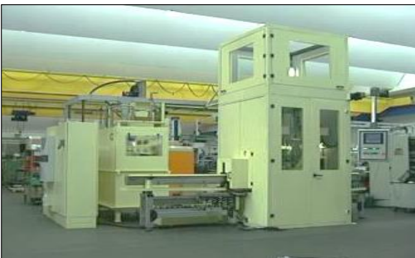
2013年度课题：轴齿类零件振动成型工艺及成套设备
